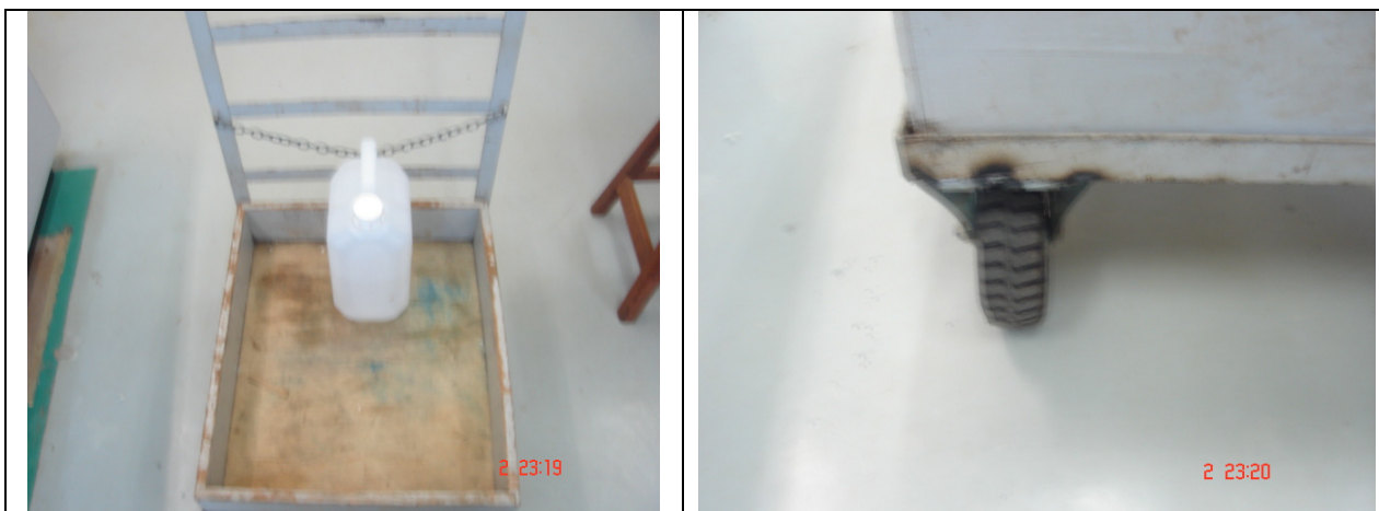
Figura 08 – Modelo de carrinho para transporte de resíduos com corrente prendendo os galões e pneu com câmera (Rodízio pneumático 6X2)
